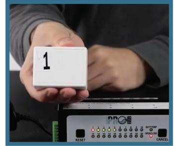
La position suivante sur le panneau sera automatiquement sélectionné pour vous permettre de synchroniser le prochain capteur. Si vous utilisez des capteurs jumelés, 1 seul des capteurs doit être associé avec l'outil-tester pour que la paire soit synchronisée.
